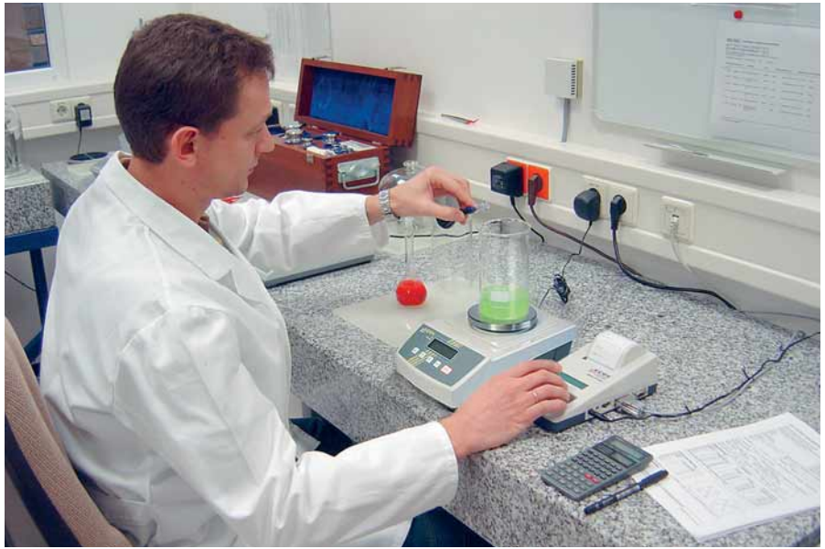
Wägeplatte A ringförmiger Windschutz serienmäßig, Ø 90 mm, Höhe 53 mm
